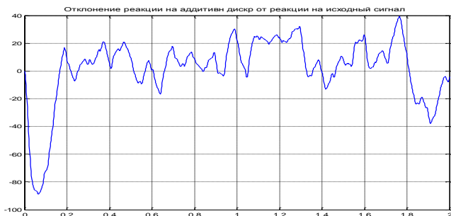
Рис.4. График отклонения реакции на аддитивную дискретизацию от реакции на исходный сигнал.
