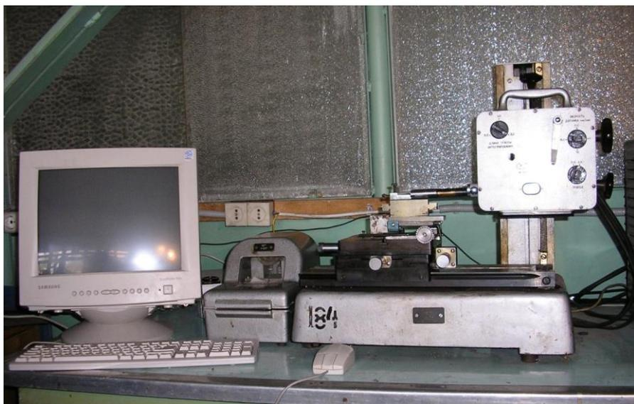
Рисунок 1 – Общий вид комплекса для записи профилограммы обработанной поверхности на ПК.
